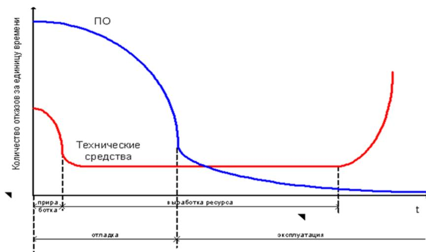
Рис. 3. График программных и аппаратных отказов по времени
