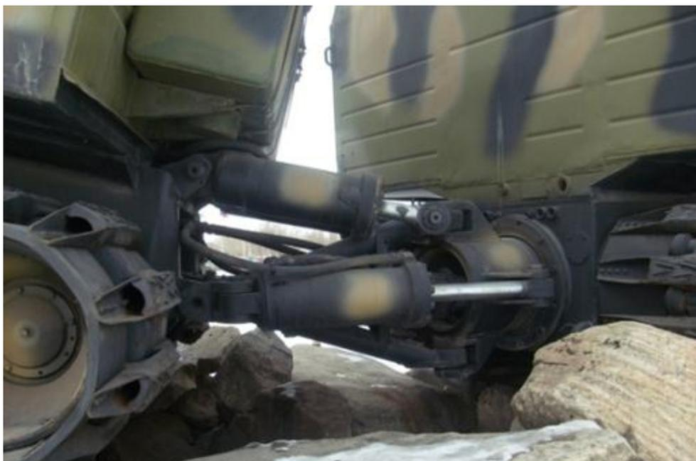
*Рис. 1.* Поворотно-сцепное устройство
