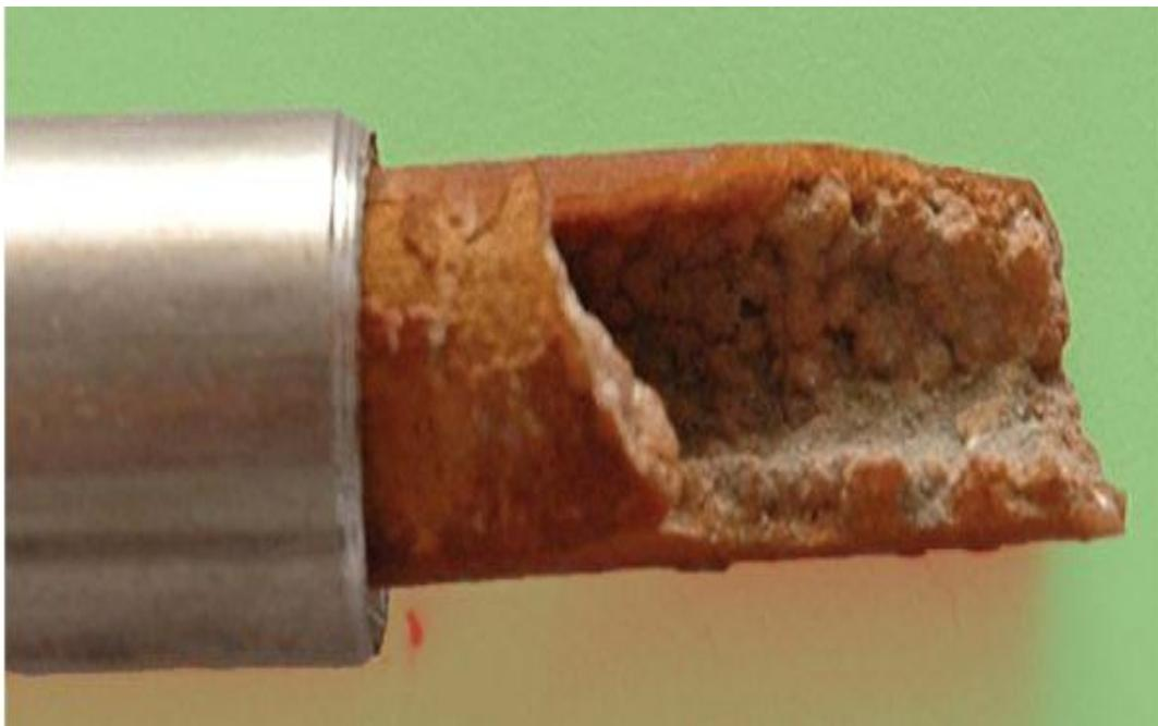
*Рис. 2.* Отложение накипи в теплообменной трубке
