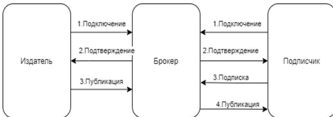
Рис. 4. Схема обмена сообщениями в протоколе MQTT
